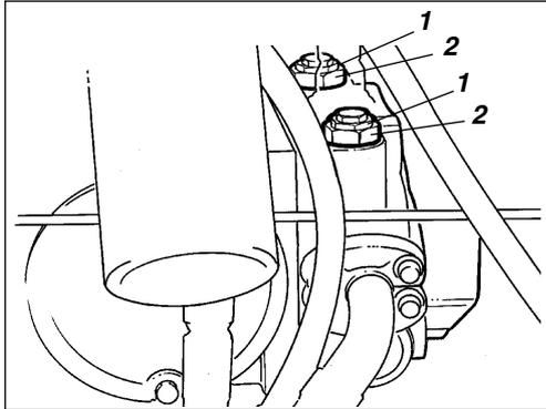
**Fig. 26 Propulsion pump**
